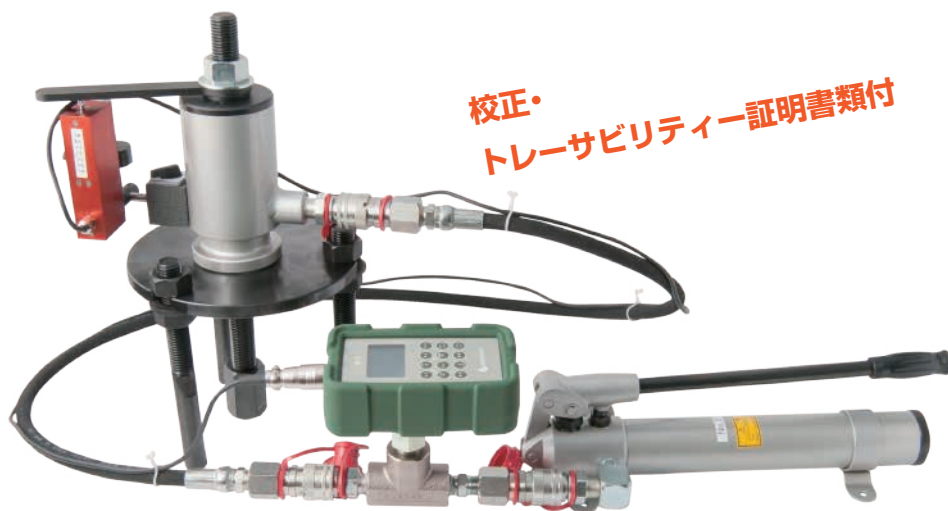
(アンカーテスター SK-8T と組合せ使用例)
